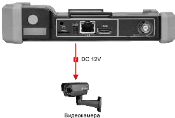
Рис. 4 Подключение питания DC 12V к видеокамере с использованием тестера
