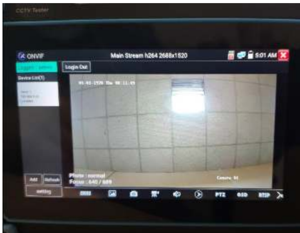
Рис. 16 Пример успешного подключения IP-видеокамеры к тестеру через ONVIF
