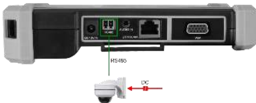
Рис.7 Подключение управляемой PTZ видеокамеры к тестеру
