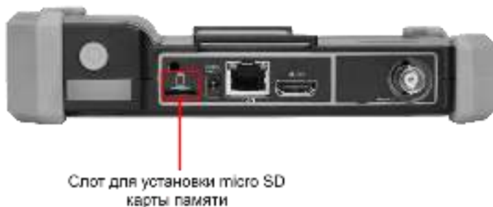
Рис. 22 Установка карты в Micro SD слот
