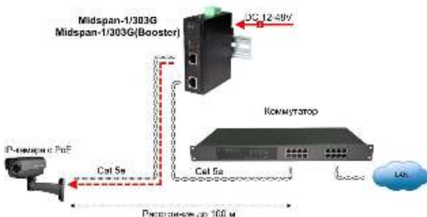
Рис.4 Типовая схема подключения инжекторов Midspan-1/303G, Midspan-1/303G(Booster)
