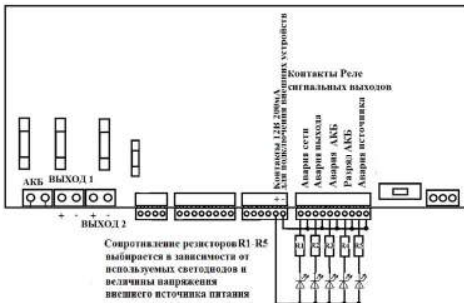
Рисунок 9 – Подключение внешних индикаторов.
