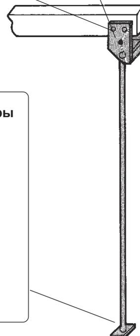
Регулировка высоты опоры
