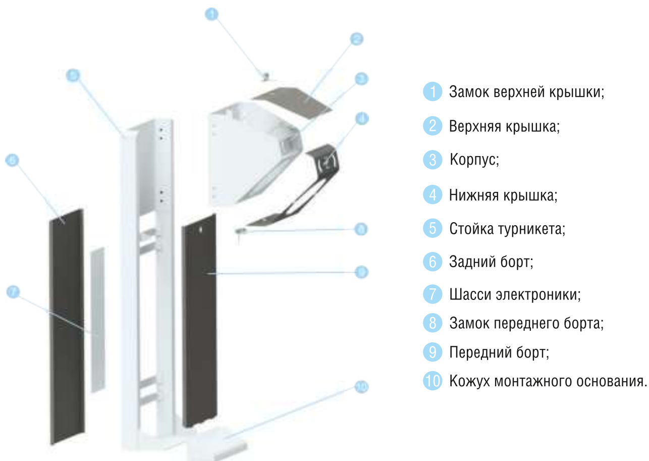
Рисунок 6.1.1 Устройство корпуса турникета
