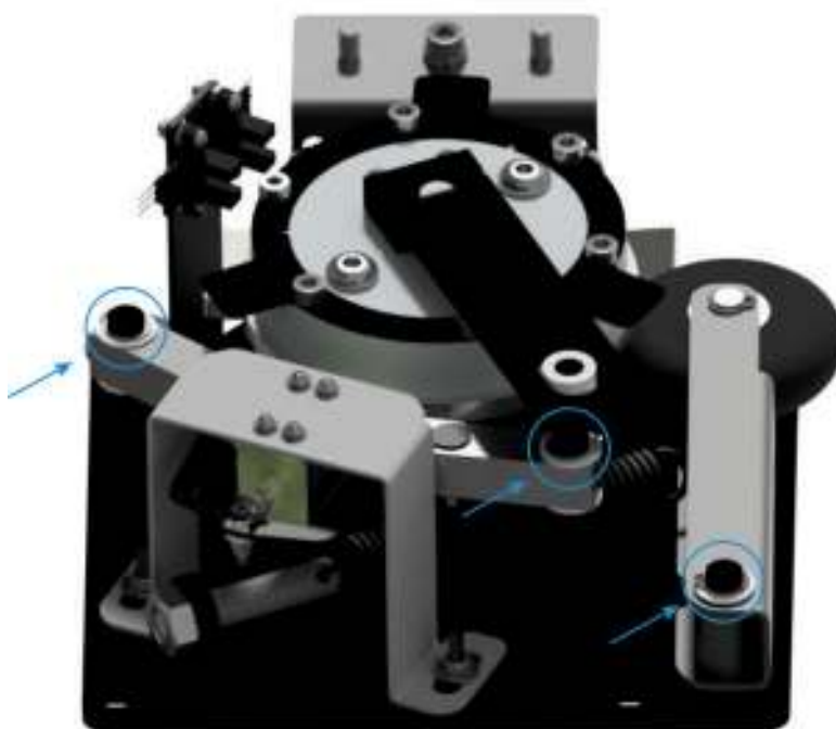
Рисунок 12.5.1 Места смазки подвижных частей
