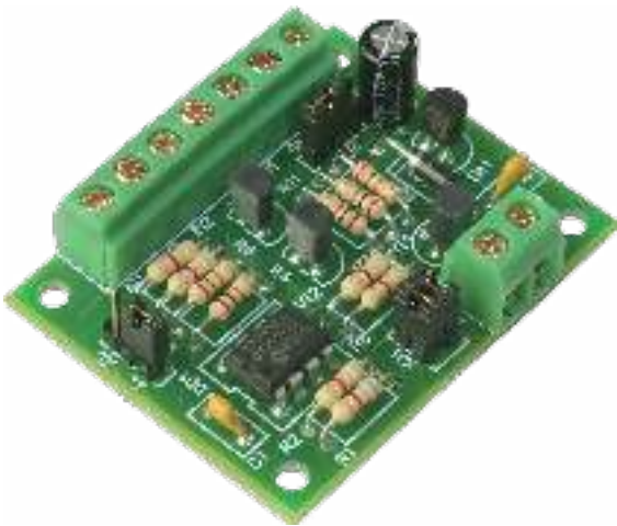
Рисунок 1. Плата модуля сопряжения с турникетами UIM-01
