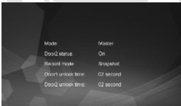
**[Режим]:** Выбор режима работы монитора – «Основной» (“Master”) и «Дополнительный» (“Slave”). В режиме «Основной» монитор связан с вызывными панелями или камерами, в режиме «Дополнительный» - с основным или дополнительными мониторами.
