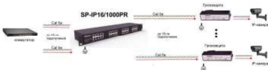
Рис. 14 Схема подключения SP-IP4/1000P, SP-IP8/1000PR, SP-IP16/1000PR, SP-IP24/1000PR на примере SP-IP16/1000PR
