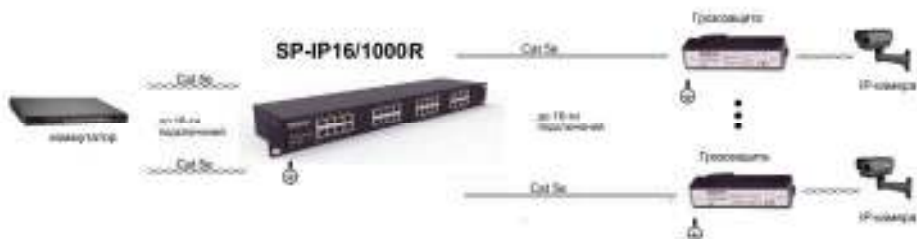
Рис. 13 Схема подключения SP-IP4/1000, SP-IP8/1000(ver.2), SP-IP16/1000R, SP-IP24/1000R на примере SP-IP16/1000R
