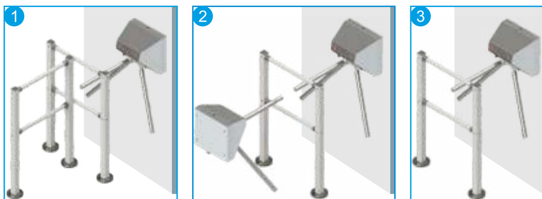
1 2 3 -турникет установлен правильно
