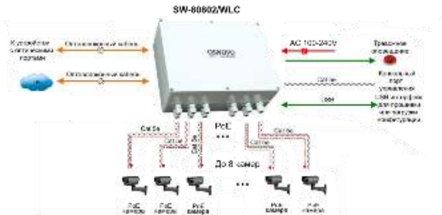
Рис.7 Типовая схема подключения коммутатора SW-80802/WLC
