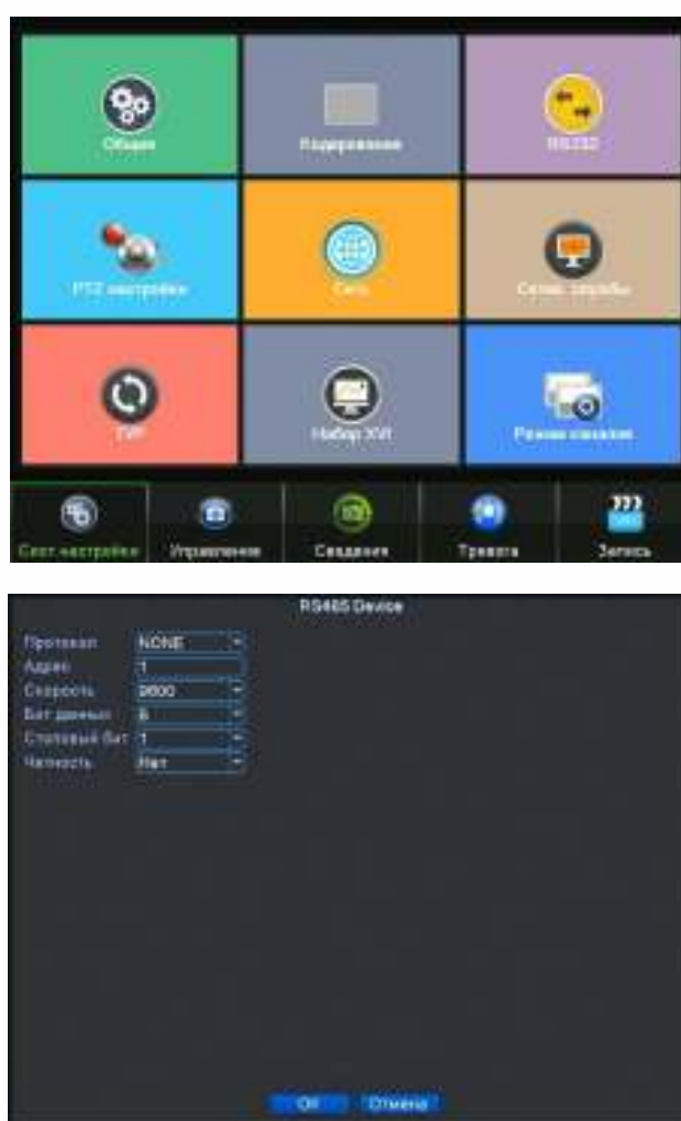
Рисунок 4.33 Конфигурация RS485 устройств в цифровом режиме.
