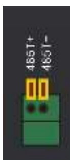
RS485 интерфейс 4 канального регистратора
