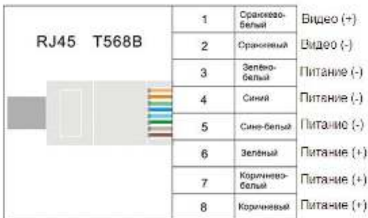
Рис.5 Распиновка разъемов RJ45
