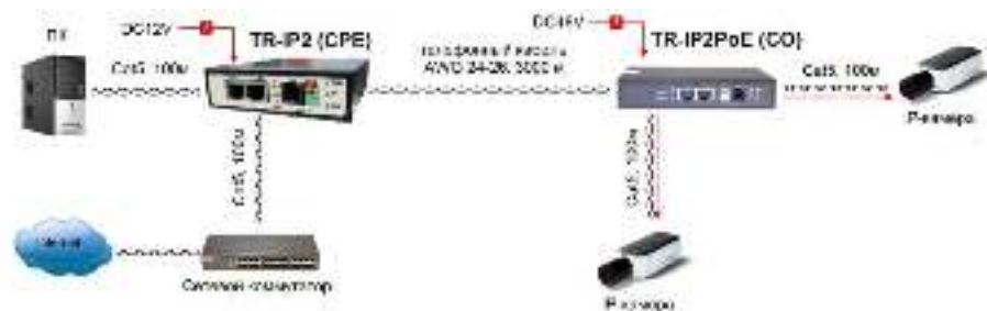
Рис. 7а Схема подключения TR-IP2PoE (CO) и TR-IP2 (CPE) для организации IP-видеонаблюдения с передачей питания на сетевые устройства.
