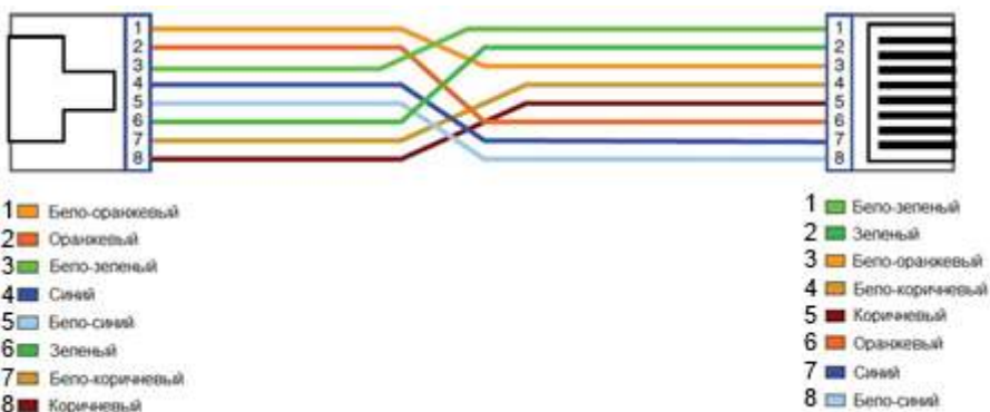
Рис. 12 Разводка кабеля по типу TIA/EIA-568-B.
