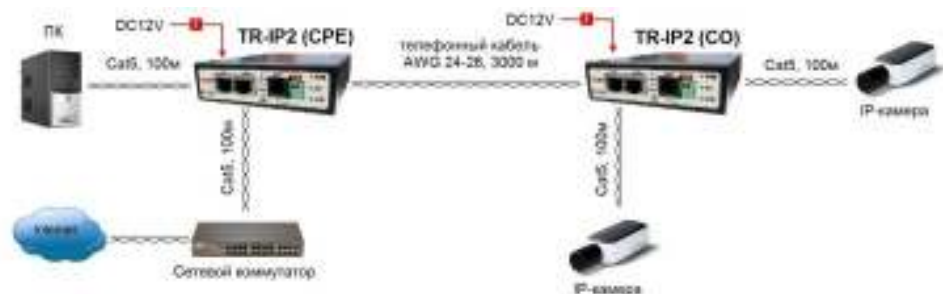
Рис. 7 Схема подключения TR-IP2 (CO) и TR-IP2 (CPE) для организации IP-видеонаблюдения.
