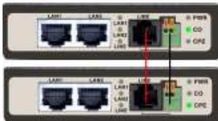
Рис. 8 Прямое соединение CO (сервера) и CPE (клиента).
