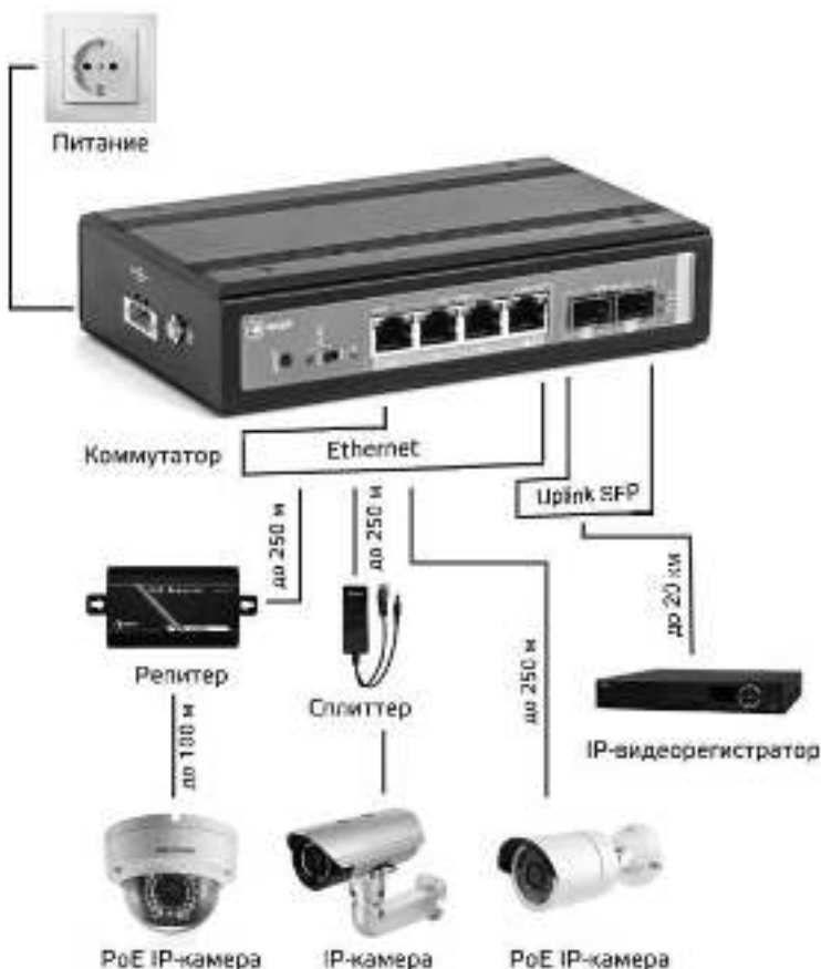
Рисунок 4 – Общая схема подключения устройств к коммутатору
