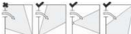
2. Допустимой высотой установки является диапазон 1,8 – 2,5 метра. Оптимальная высота – 2,2 метра.
