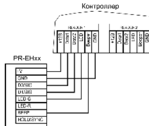
Рисунок 7. Подключение считывателя по интерфейсу Wiegand
