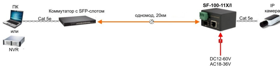
Рис. 6 Схема подключения SF-100-11X/I
