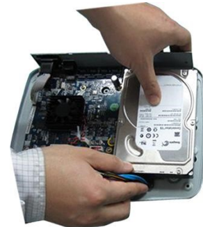
Падключыце SATA кабель і кабель харчавання на ніжняй і задняй частцы корпуса і зачыніце корпус верхняй вечкам.
