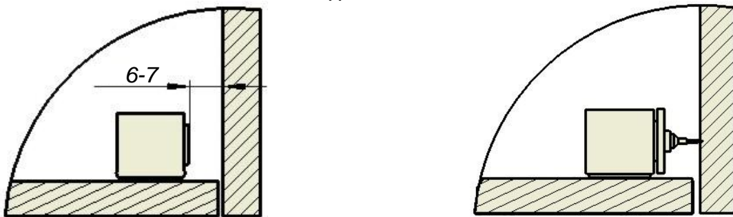
Примеры монтажа защёлки на шкаф с распашной дверью (А) и на выдвижной ящик (Б и В)
