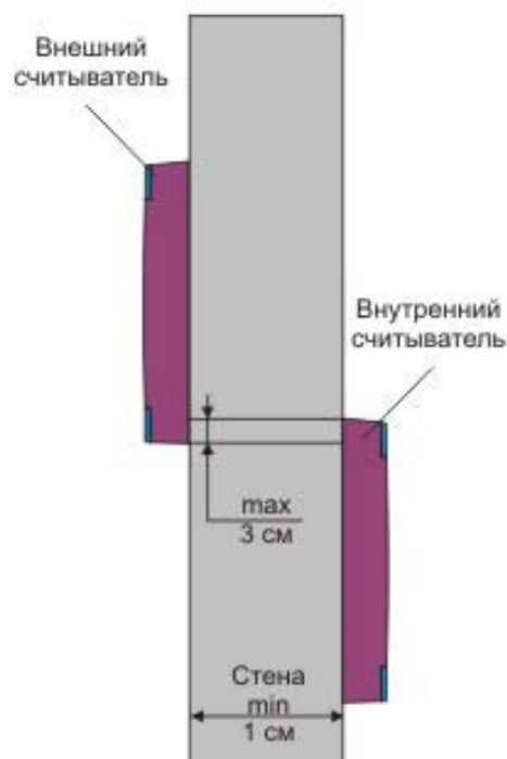
Рисунок 5. Крепление считывателей с разнесением по вертикали.
