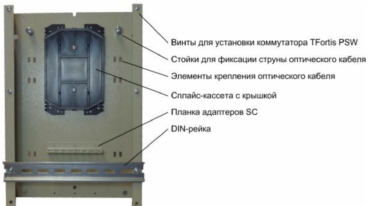
Рис. 3. Оптический кросс
