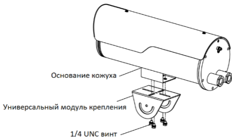
Рисунок 2-3 Установка камеры на модуль крепления
