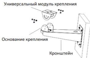
Рисунок 2-2 Удаление модуля крепления
