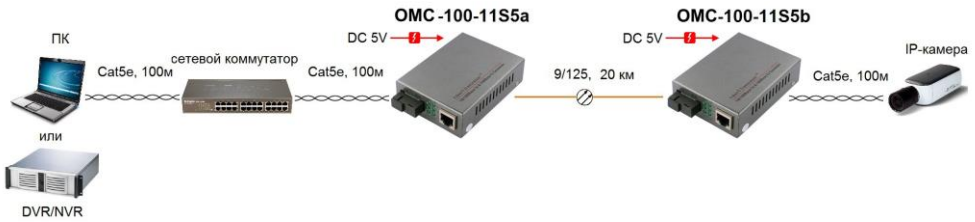
Рис. 6 Схема подключения медиаконвертеров OMC-100-11S5a (OMC-100-11S5b)
