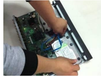
Падключыце SATA кабель і кабель харчаванні на ніжняй і задняй частцы корпуса і зачыніце корпус верхняй вешкам.
