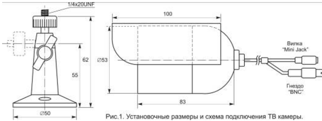
Рис.1. Установочные размеры и схема подключения ТВ камеры.
