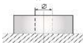
Тип клемм под болт М6
