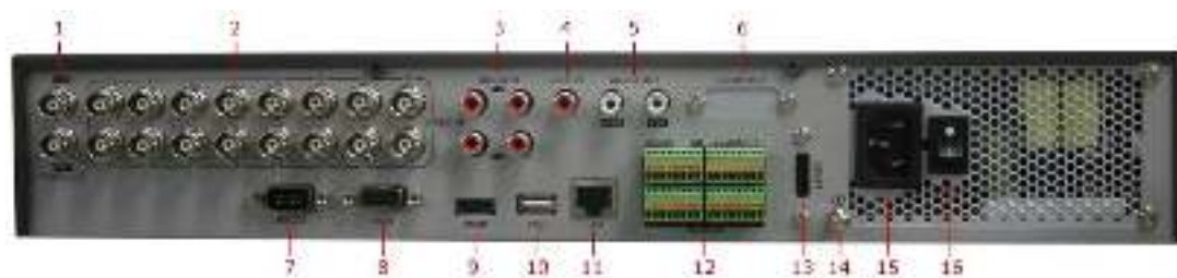
Рисунок 1.6 Задняя панель DS-7316HI-ST&amp;DS-7316HFI-ST
