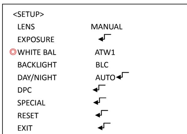
**ATW (автоматическое отслеживание баланса белого):** Этот режим может быть использован в пределах цветовой температуры 1800 ° K ~ 10,500 ° K (например, флуоресцентный свет, на улице, натриевая лампа и т.д.)
