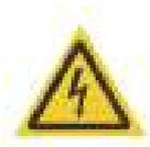
Этот символ предназначен для предупреждения пользователя о наличии неизолированного напряжения внутри корпуса устройства, которое может быть достаточным, чтобы создать опасность поражения электрическим током человека.
