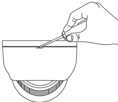
С помощью тонкой отвертки, подденьте край крышки купола, и он легко отделится от основания.
