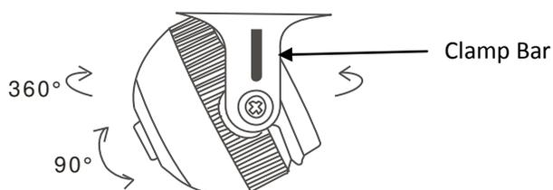
После настройки угла наклона камеры, для закрытия корпуса сначала совместите **Clamp Bar**, который представляет собой пластиковый выступ (смотри рисунок), с вертикальными направляющими на внутренней поверхности купола. Это позволит вращать модуль совместно с крышкой купола в горизонтальной плоскости. Соедините крышку купола с основанием в обратном порядке и затем направьте камеру в нужном направлении.
