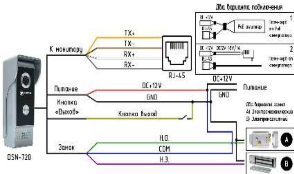
Маркировка проводов для подключения панели:
