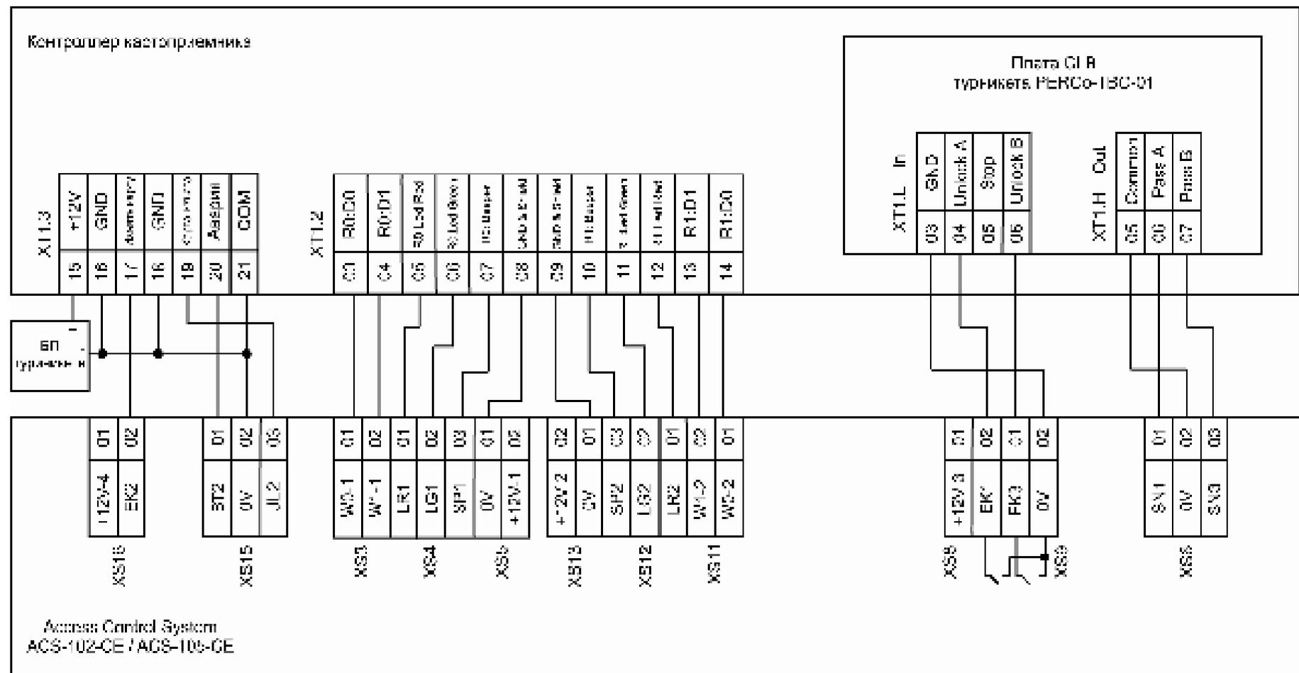
Запрещается питать турникет или картоприемник от контроллера. 0V блока питания турникета (картоприемника) и 0V контроллера должны быть объединены. В настройках картоприёмника включите контроль сигнала “Карта изъята”.
