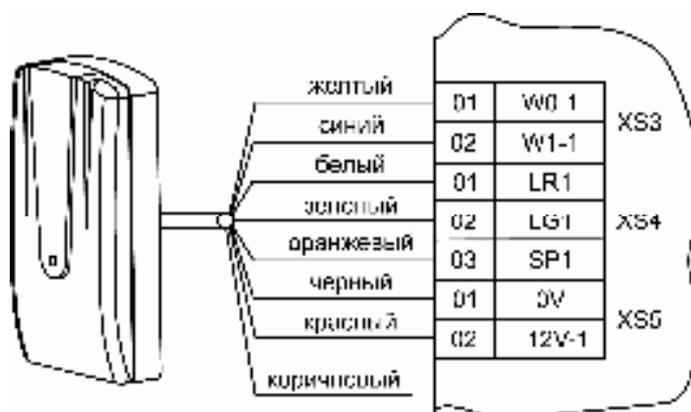
Для обеспечения работы двух считывателей в режиме Синхронизации (при установке двух считывателей на тонкую (меньше 20 см.) стену с противоположных сторон) соедините выводы (коричневые) данных считывателей между собой.
