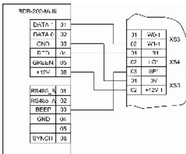
Для обеспечения работы двух считывателей в режиме Синхронизации (при установке двух считывателей на тонкую (меньше 20 см.) стену с противоположных сторон) соедините контакты SYNCH данных считывателей между собой.
