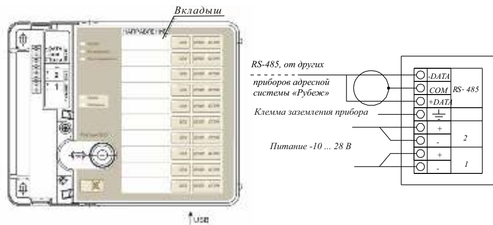
Рисунок 1 – Внешний вид и схема подключения прибора
