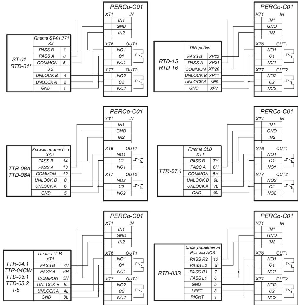
\* - для скоростного прохода PERCo-ST-01(STD-01) выходы PASS A и PASS B должны быть сконфигурированы как нормально разомкнутые
