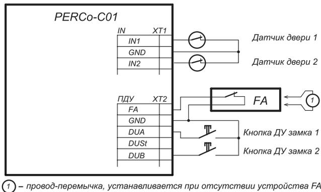
Схема подключений кнопок ДУ и датчиков двери
