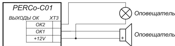
Схема подключений дополнительного оборудования к выходам контроллера типа «Открытый коллектор»
