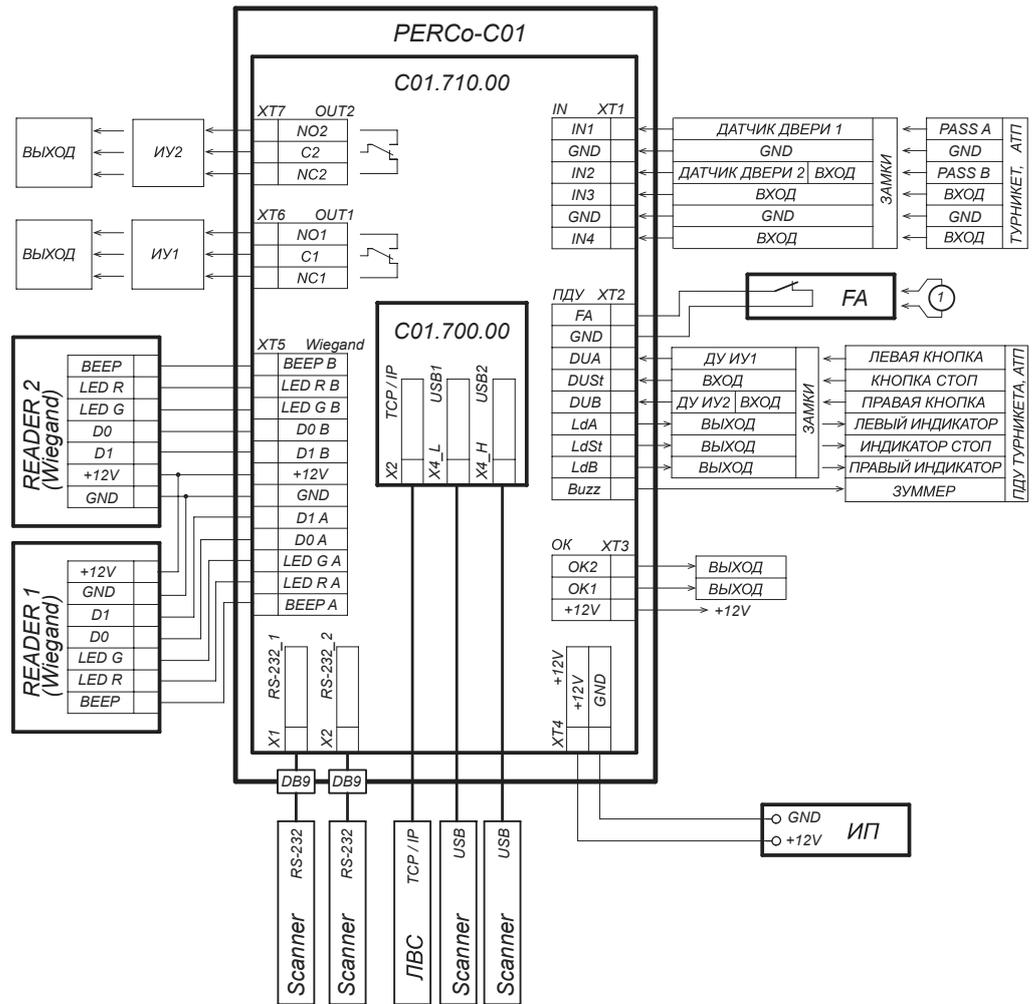
① – провод-перемычка, устанавливается при отсутствии устройства ФА
