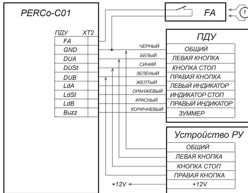
① – провод-перемычка, устанавливается при отсутствии устройства FA
