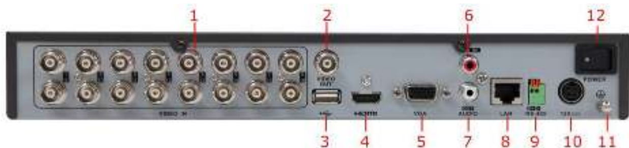
Рисунок 1.4 Задняя панель DS-7204HVI-SH/HFI-SH
