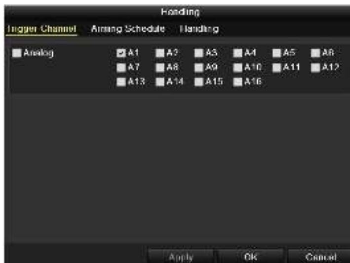
Рисунок 8.3 Установка камер, реагирующих на тревогу
