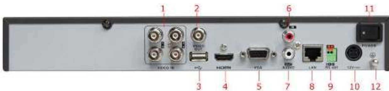
Рисунок 1.4 Задняя панель DS-7204HVI-SH/HFI-SH
