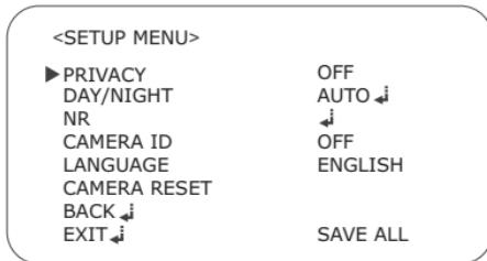
Коды для функции **PRIVACY** выбрано значение **ON**, квадратная рамка отобразится на экране. Нажмите центральную кнопку переключателя, и следующее подменю отобразится на экране:
