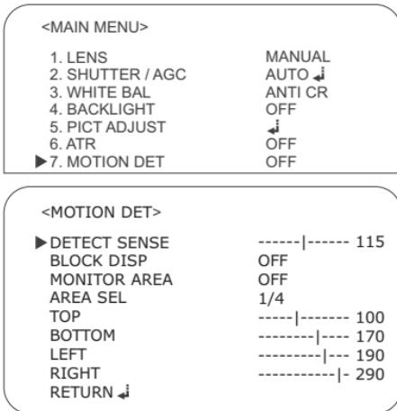
Этот продукт имеет функцию, которая позволяет наблюдать движение объектов в выбранной области на экране.
