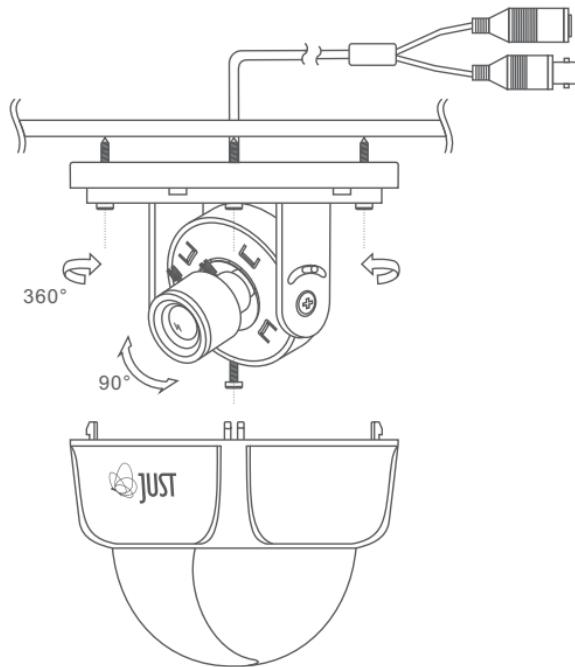
1. Приклейте монтажный шаблон в место, где планируется установка камеры. Основание купола крепится четырьмя винтами #10, которые поставляются в комплекте через четыре отверстия в основании купольной камеры.
