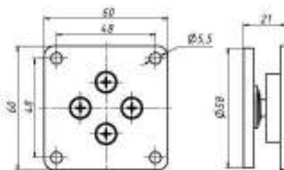
Рисунок 3 - Габаритные размеры корпуса
