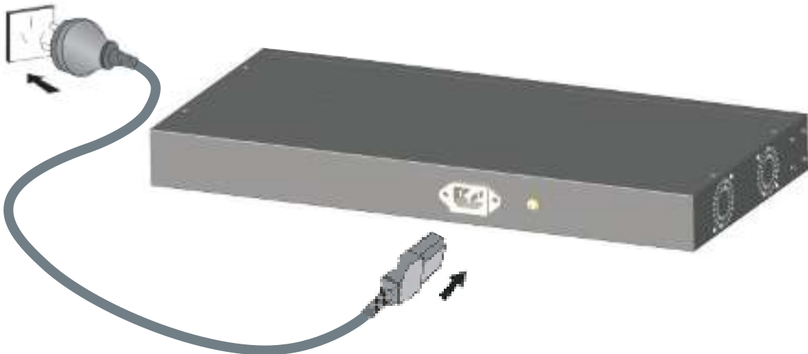
Рис. 3.7. Подключение кабеля электропитания
