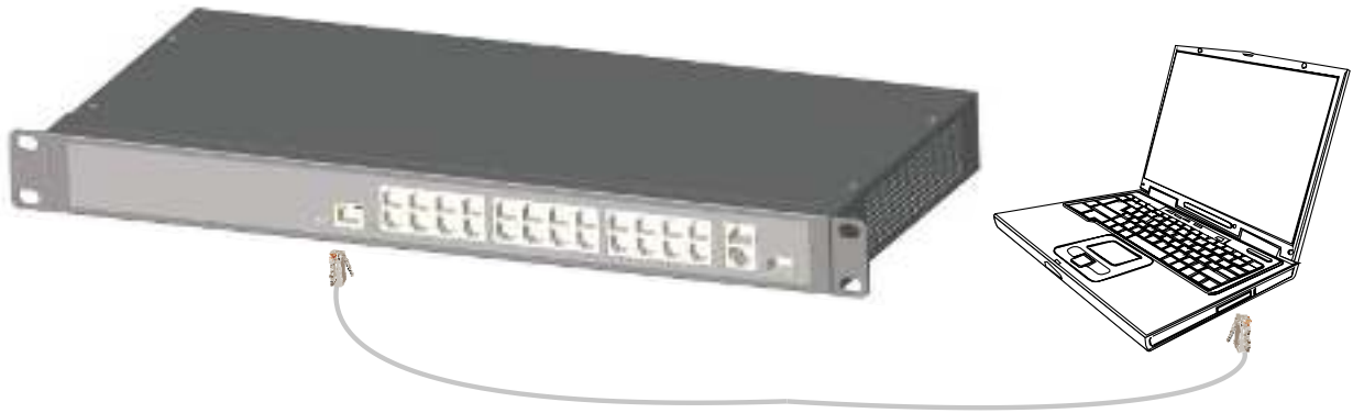
Рис. 3.6. Подключение компьютера к консольному порту
