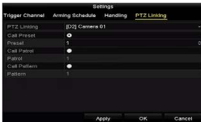
Рисунок 9-17 Установка привязки PTZ
