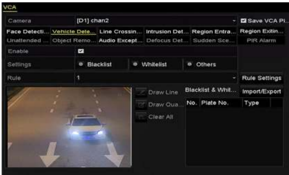
Рисунок 10-3 Установка обнаружения ТС
