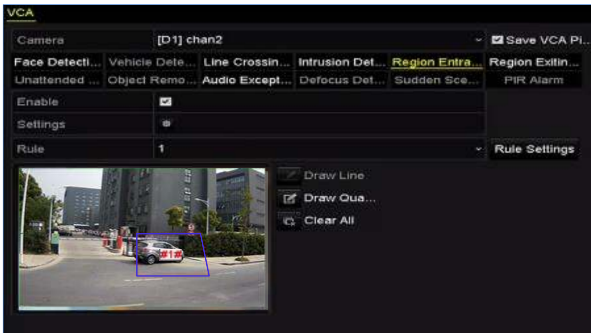
Рисунок 10-9 Установка области обнаружения входа в регион
