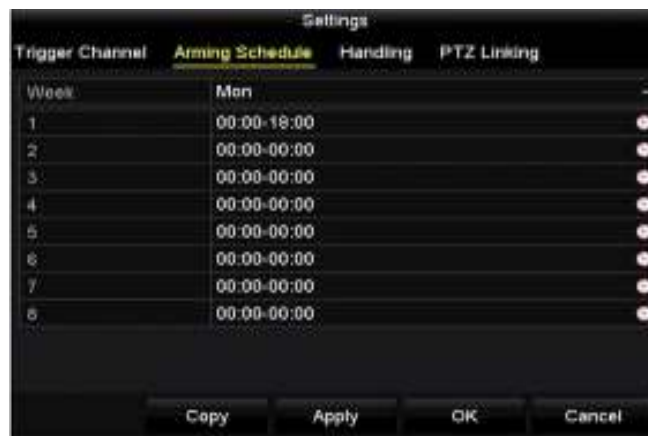
Рисунок 9-16 Установка расписания постановки на охрану
