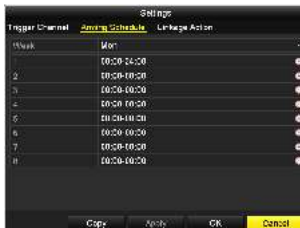
Рисунок 8-3 Установка расписания постановки на охрану обнаружения движения
