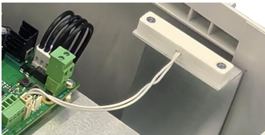
Рисунок 3.6.2 - Датчик вскрытия в корпусе коммутатора
