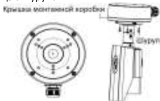
Рисунок 2-4 Установка камеры с монтажной коробкой
