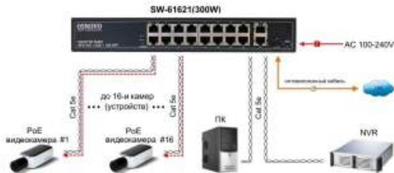
Рис.4 Типовая схема подключения коммутатора SW-61621(300W)
