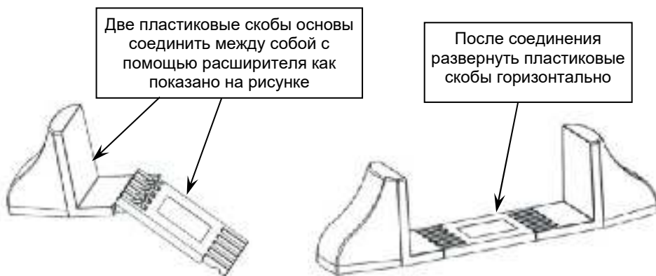
Рисунок 3 - Сборка пластиковых основ и расширителя для вертикальной установки изделия с ИБП.
