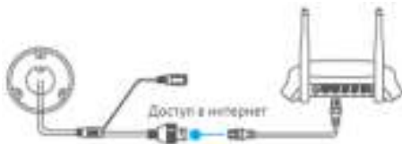
Рисунок 5-3 Подключение к роутеру
