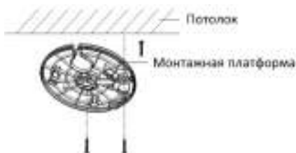
Рисунок 2-3 Установка монтажной платформы
