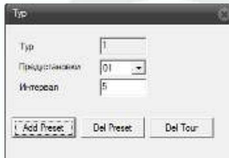
Тур представляет из себя последовательность пресетов (предустановок), по которым в заданной последовательности перемещается камера, останавливаясь на каждой позиции на заданный интервал времени.
