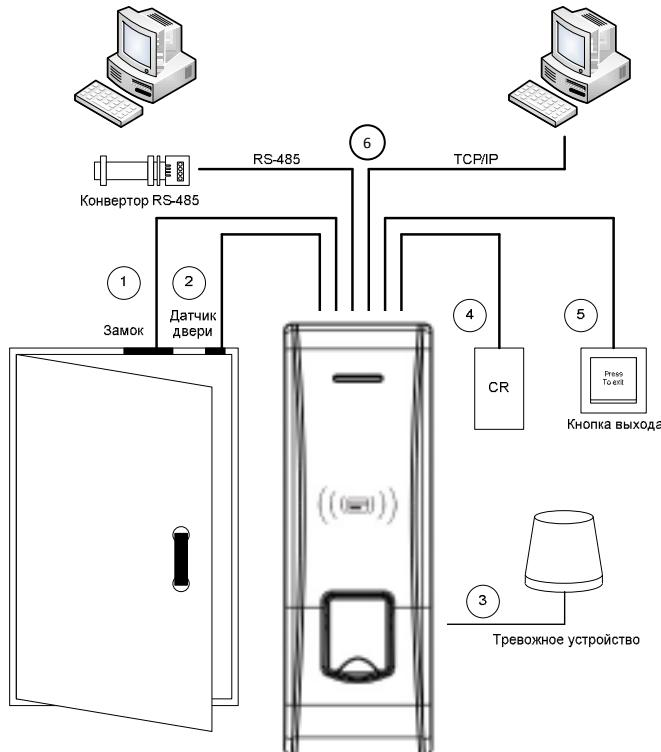
1. При проходе пользователя и успешной идентификации ST-FR031EM разблокирует дверь.
