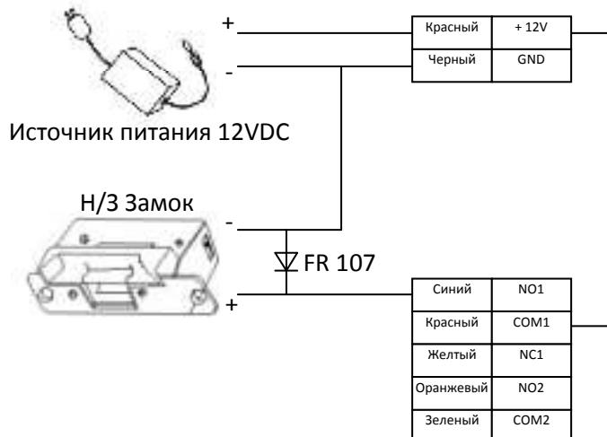
**Подключение электрозамка при использовании отдельных источников питания**
