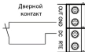
Рис.6. Подключение дверного контакта
