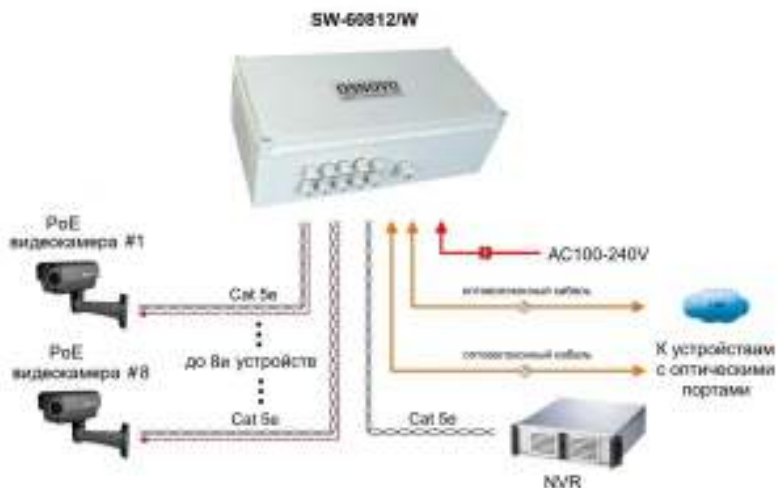
Рис.6 Типовая схема подключения коммутатора SW-60812/W
