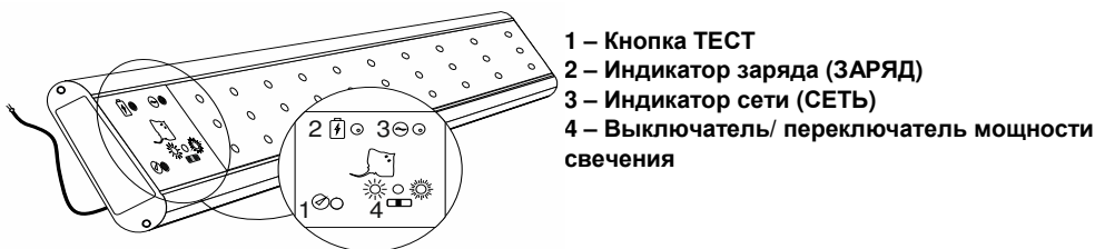
Рисунок 1 - Общий вид, назначение органов управления и индикации.
