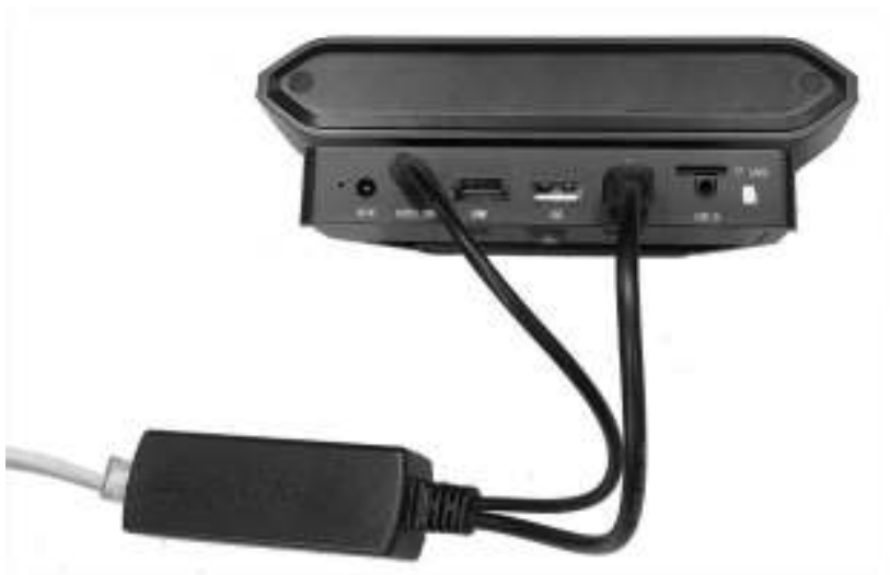
Рисунок 3. Подключения устройства по технологии PoE
