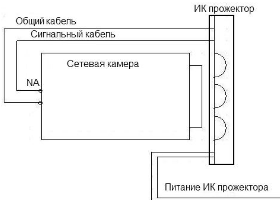
Рис. 8 Схема подключения ИК прожектора
