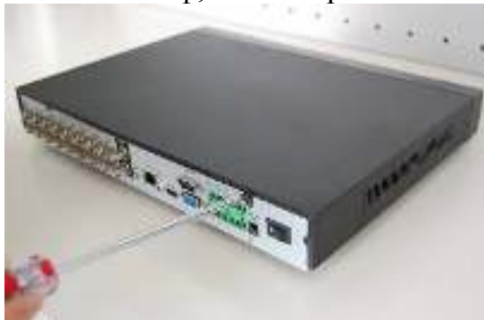
Открутите винты крепления крышки сзади
