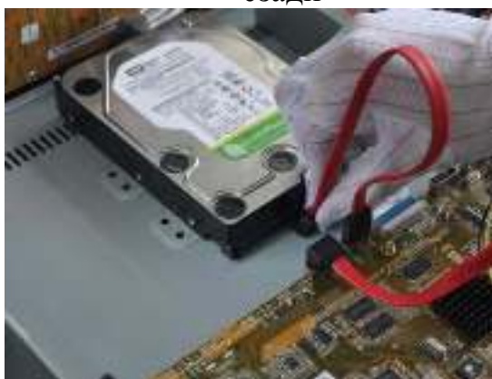
Подключите кабель данных и питания к HDD
